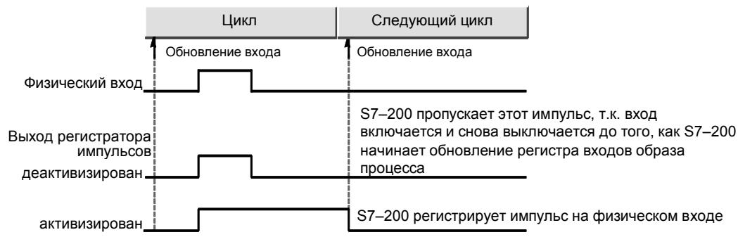
Рис. 4–25. Функционирование S7-200 с активизированным и деактивизированным регистратором импульсов
