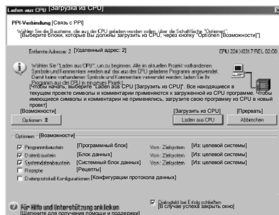
Рис. 4–14. Загрузка проекта из CPU S7-200 в компьютер
